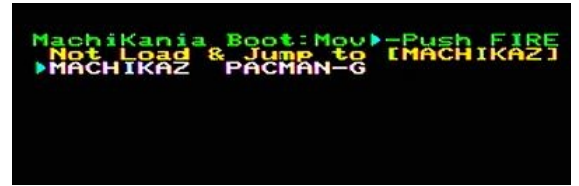
ブートローダ画面。初めて使用する時と、どれかボタンを押しながら電源オンまたはリセットすると起動します。
